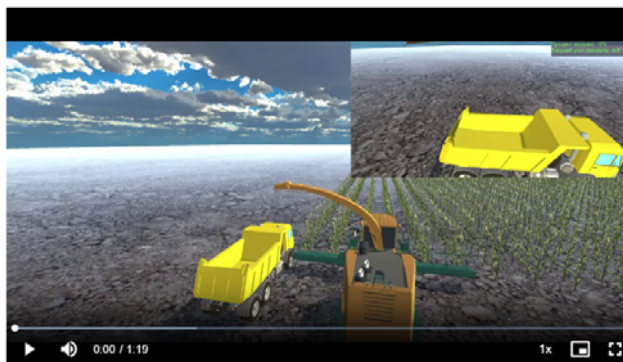
Рис. 1. Фрагмент видеоролика цифрового двойника, реализованного в среде Unity .
