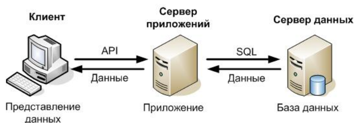
Рис. 3. Архитектура программного комплекса
