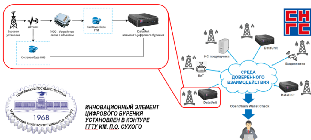
Рис. 2. Пример создания среды доверенного взаимодействия всех участников бурового процесса на основе информации из различных источников с применением современных инструментов цифрового бурения
