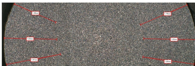
Рис. 1. Микроструктура катанки из стали ШХ15 диаметром 6,5 мм, \times 50
