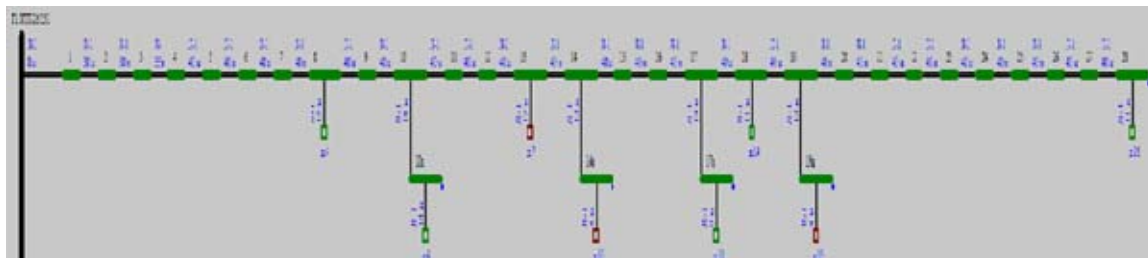
Рис. 2. Фрагмент схемы электрической сети 0,4 кВ поселка Подозерье в программе LineCapacity
