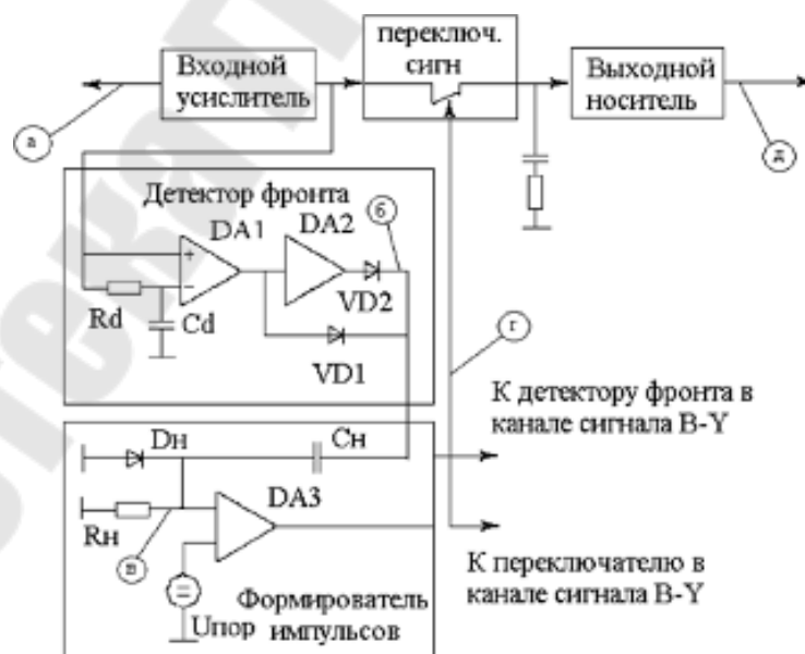
Рис. 4.6. Функциональная схема микросхемы К174ХА27
