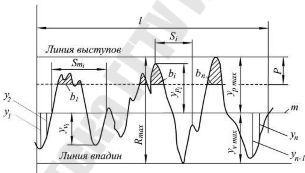
Рис.4.1. Профилограмма к определению основных параметров шероховатости поверхности
