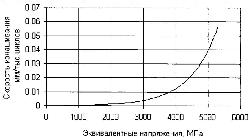
Рис. 6. Зависимость скорости изнашивания рабочей поверхности матриц от величины эквивалентных напряжений
