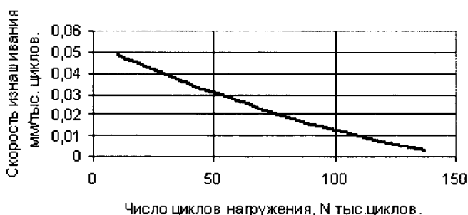
Рис. 4. Изменение скорости изнашивания формообразующей поверхности матриц в зависимости от длительности их эксплуатации
