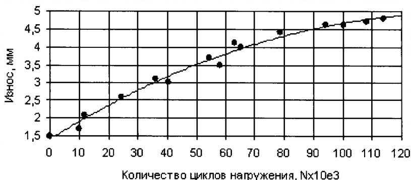
Рис. 3. Зависимость радиуса сопряжения формообразующей поверхности с отверстием под стержень болта матриц от числа циклов нагружения инструмента
