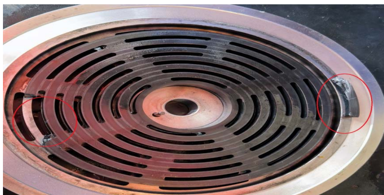
Рис. 1. Изображение повреждения пластины клапана
