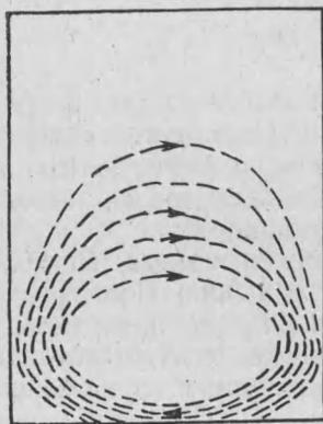
Рис. 3. Схема циркуляции воздуха в замкнутом объеме с нагреваемой вертикальной поверхностью
