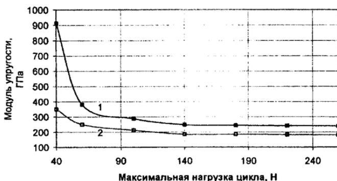
Рисунок 3 – Зависимость расчетного значения модуля упругости от величины приложенной к индентору нагрузки; максимальное (1) и минимальное (2) значения рассчитанной величины для одного и того же цикла нагружения.
