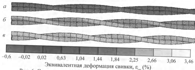
Рис. 6. Сравнение деформированного состояния металлокорда: Схемы свивки n+n_0 : а — 20 + 10 ; б — 20 + 15 ; в — 20 + 20
