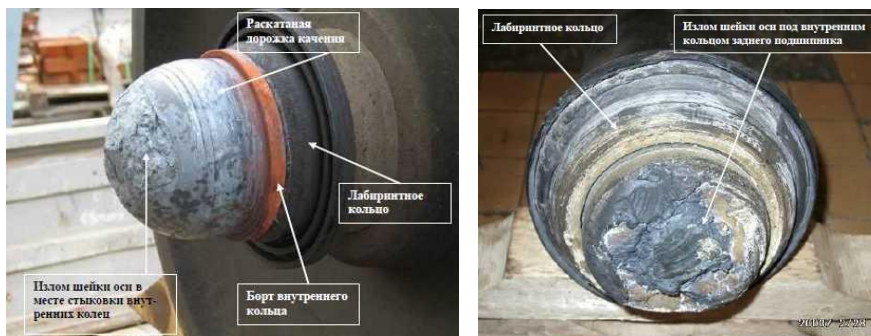
Рисунок 1 – Нарушение прочности соединений с натягом вагонной колесной пары в эксплуатации
