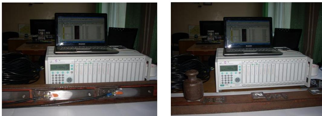
Рисунок 2 – Размещение тензорезисторов и тарировка устройства
