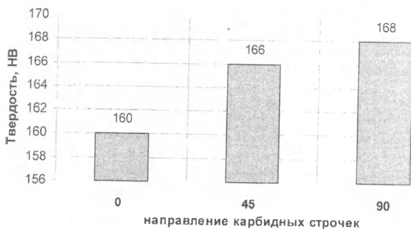
Рис. 2 – Результаты оценки твердости (НВ) образцов в зависимости от расположения их текстуры по отношению к линии приложения внешних сил.
