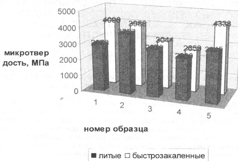
Рисунок 1 – Сравнительные значения микротвердости литых и быстрозакаленных образцов разного химического состава
