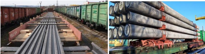
Рисунок 1 – Размещение длинномерных грузов на сцепе вагонов
