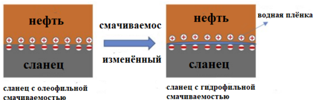
Рис. 3. Иллюстрация добавления ионных ПАВ к гидрофобной породе, показывающая как электростатические взаимодействия способствуют отделению нефти от поверхности породы и изменению смачиваемости
