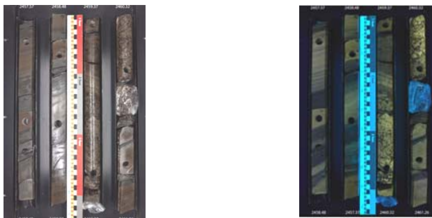
Рис. 6. Пример точек отбора образцов для лабораторных исследований на керне (слева – фото без ультрафиолета, справа – фото под ультрафиолетом) на примере скважины 75 Северо-Домановичская
