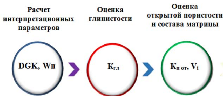
Рис. 2. Схематический алгоритм интерпретации данных геофизических исследований скважин
