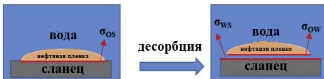
Рис. 2. Иллюстрация добавления ПАВ к гидрофобной породе, показывающая удаление слоя нефти с поверхности породы за счет образования устойчивого слоя воды между поверхностью породы и слоем нефти
