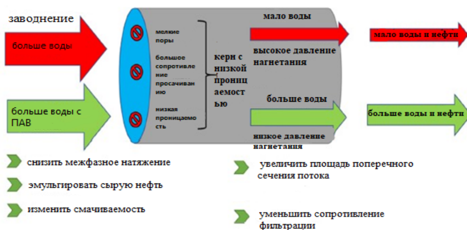
Рис. 1. Схема влияния ПАВ на отмыв остаточной нефти при добавлении его в нагнетаемую воду
