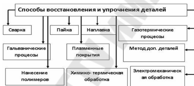
Рис. 1.1 - Способы восстановления и упрочнения поверхностей деталей
