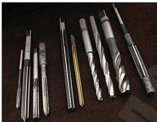
Рис. 2.15 - Развертка – режущий инструмент, который нужен для окончательной обработки отверстий после сверления, зенкерования или растачивания
