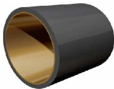
Рис. 3.25 - Пример наплавленной детали – втулка. Основа – сталь 3, наплавленный слой – латунь ЛМцС58-2-2
