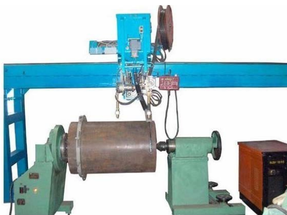
Рис. 3.9 - Установка УНВ-3-5 для дуговой наплавки тел вращения
