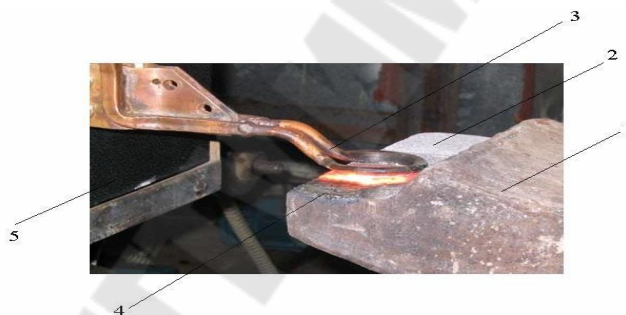
Рис. 3.22 - Наплавка опорной плиты петлевым индуктором: 1 – изделие; 2 – слой шихты; 3 – петлевой индуктор; 4 – наплавленный слой; 5 – высокочастотный генератор
