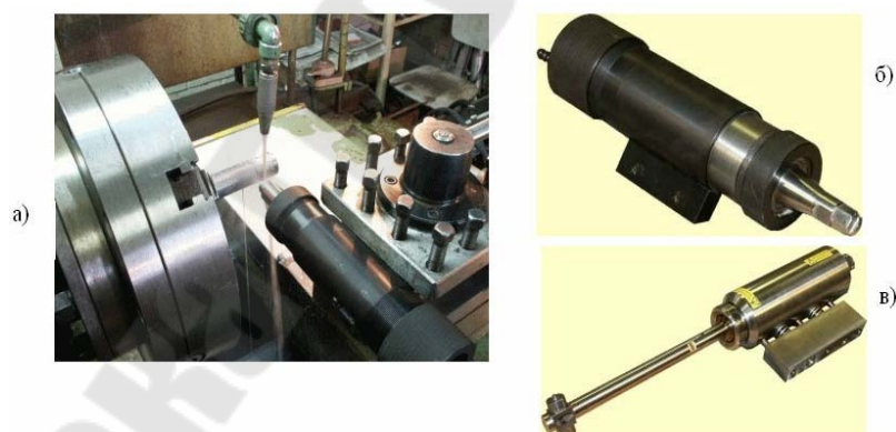
Рис. 2.13 - Ультразвуковая импульсная упрочняюще-чистовая обработка деталей: а – упрочнение цилиндрической детали на токарном станке; б – инструмент для обработки внешних поверхностей; в – для обработки внутренних поверхностей
