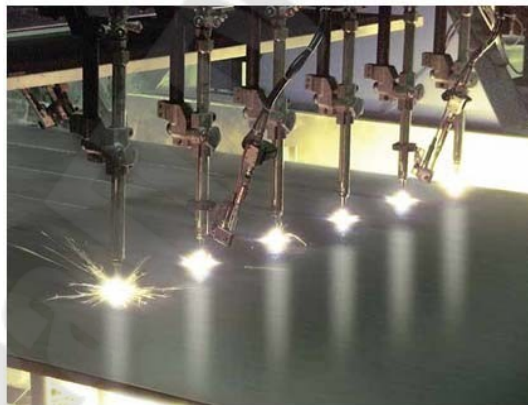
Рис. 2.2 - Термическая правка листовой стали
