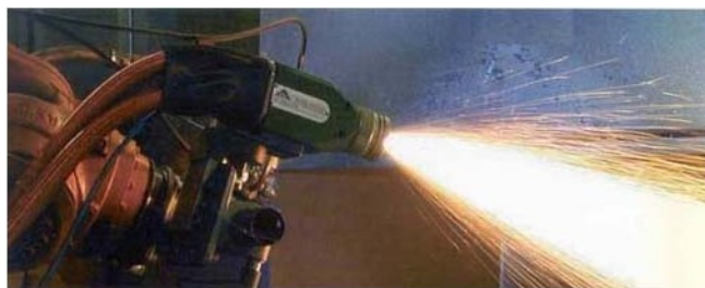
Рис. 4.7 - Работа металлизатора при нанесении покрытия
