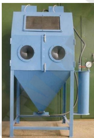
Рис. 1.2 - Камера для дробеструйной обработки деталей (стационарная)
