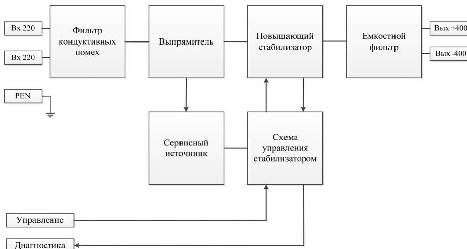
Рис. 3. Функциональная схема выпрямителя с регулятором коэффициента мощности
