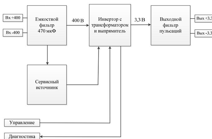
Рис. 4. Функциональная схема одного канала стабилизатора напряжения
