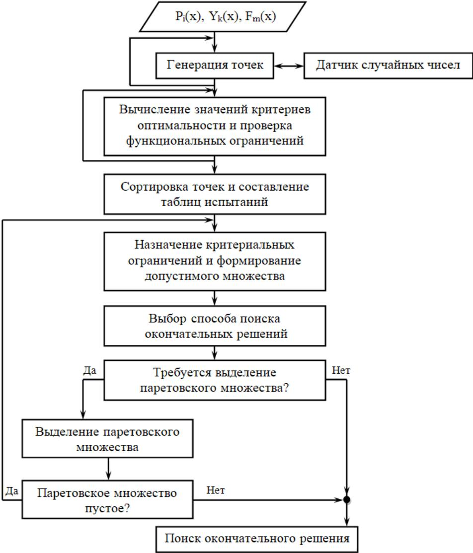
Рис. 5.30. Схема алгоритма диалогового метода многокритериальной оптимизации
