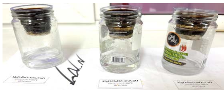
Рис. 5. Изображение фильтров, изготовленных из мишени на основе оксида магния, обработанных при температурах от 400 до 650 °С
