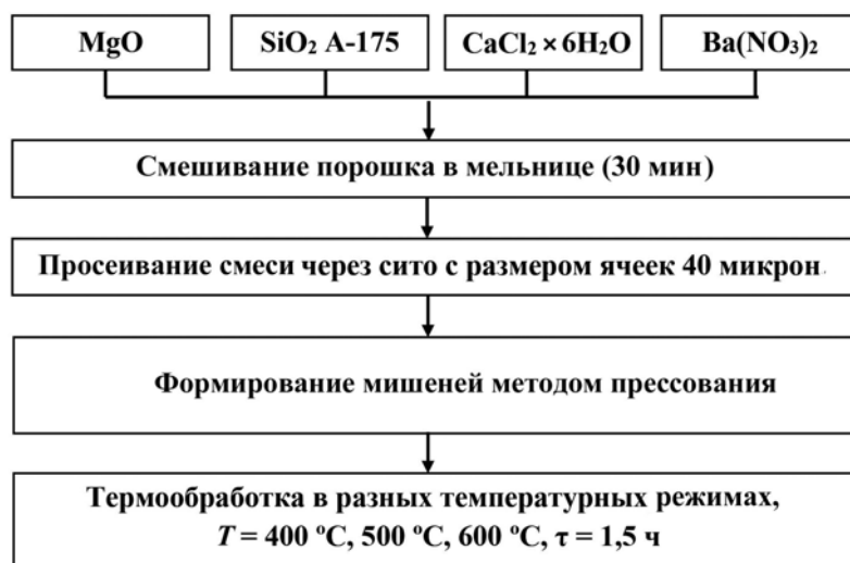
Рис. 1. Технологическая схема получения нанокompозита на основе оксида магния и исследование его свойств
