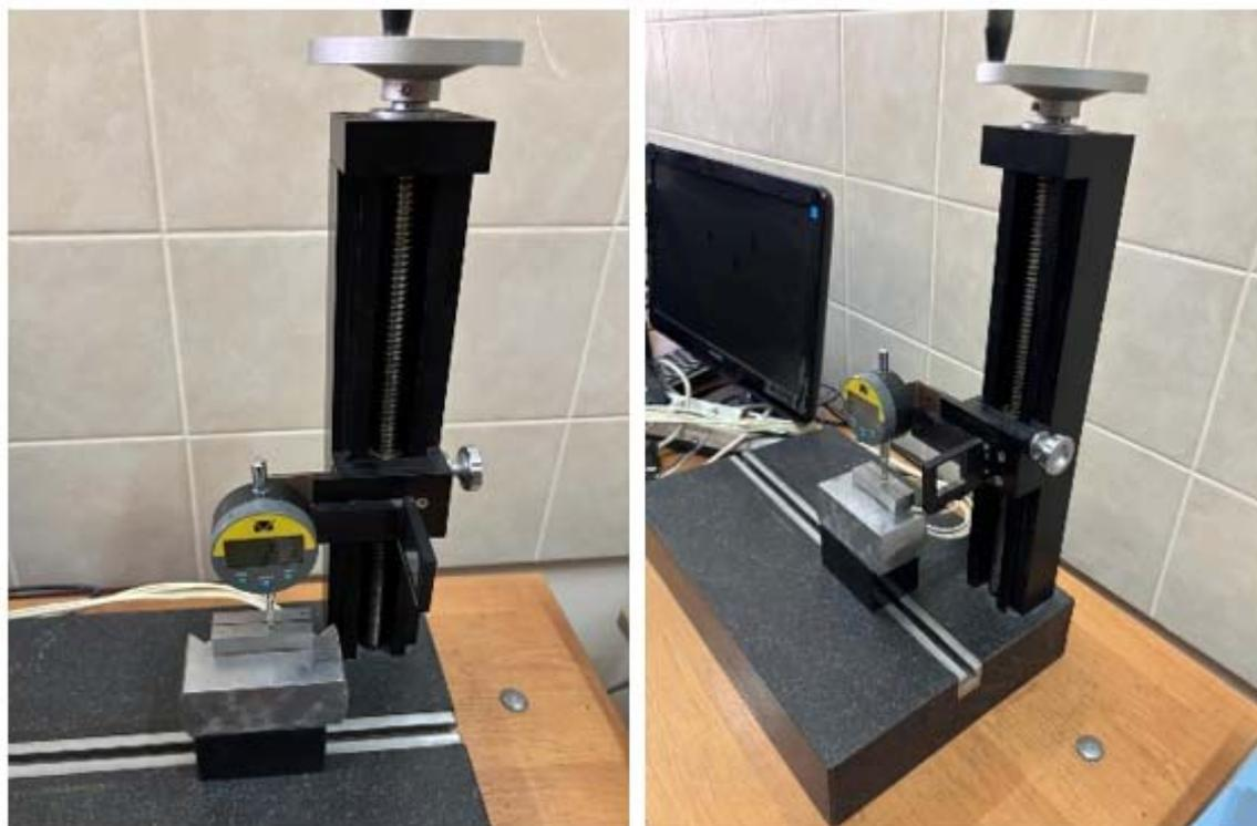
Рис. 1. Приспособление для измерения отклонений от плоскостности и прямолинейности
