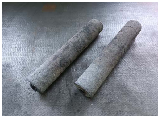
Рис. 2. Полученные заготовки из износостойкого хромистого чугуна
