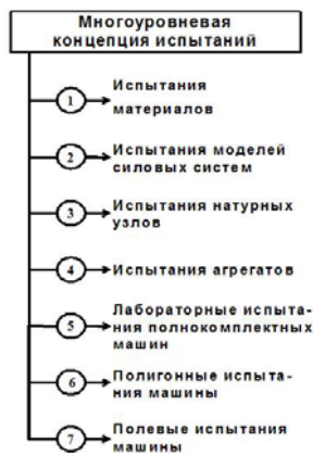
Рис. 1. Последовательный ряд уровней испытаний
