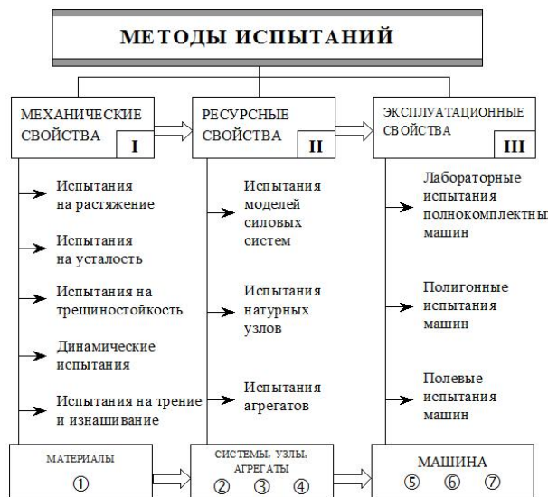
Рис. 3. Комплексная система испытаний сельскохозяйственных машин
