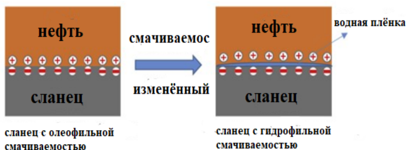
Рис. 2. Иллюстрация добавления ионных ПАВ к гидрофобной породе, показывающая, как электростатические взаимодействия способствуют отделению нефти от поверхности породы и изменению смачиваемости
