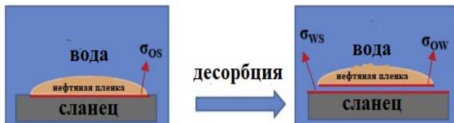
Рис. 1. Иллюстрация добавления ПАВ к гидрофобной породе, показывающая удаление слоя нефти с поверхности породы за счет образования устойчивого слоя воды между поверхностью породы и слоем нефти
