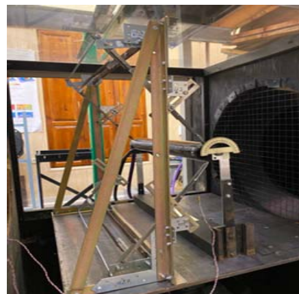
Рис. 1. Схема (а) и фото (б) исследуемой модели со стержнями-турбулизаторами
