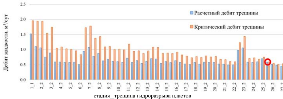
Рис. 2. Критический дебит жидкости по стадиям для скважины 445g Речицкая, при котором вероятен вынос проппанта
