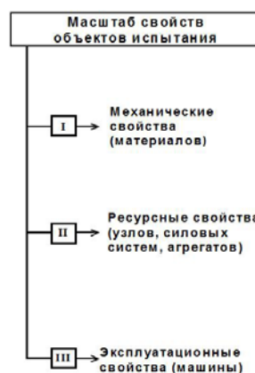
Рис. 2. Иерархическая структура свойств испытываемых объектов
