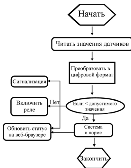
Рис. 4. Алгоритм для правильной работы датчиков
