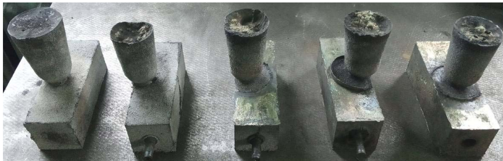
Рис. 2. Экспериментальные детали «Вкладыш отбойный» I, II, III, IV, V слева направо после выбивки
