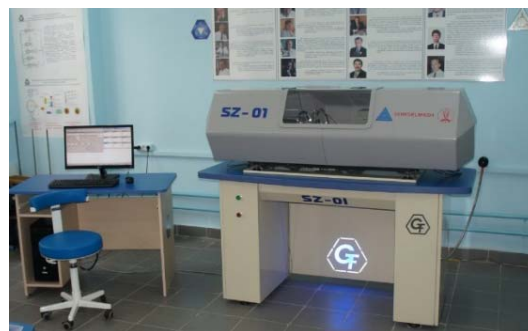
Рис. 5. Стенд для модельных комплексных износоусталостных испытаний типа SZ
