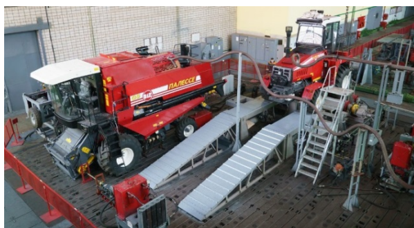
Рис. 4. Стенд для натуральных испытаний полнокомплектных самоходных машин
