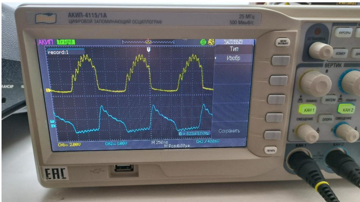
Рисунок 3 – Графики временной зависимости напряжений на электродах полевого транзистора
