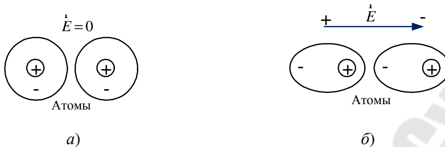
Рис. 3.6. Электронная поляризация: а – при отсутствии электрического поля; б – при включении электрического поля
