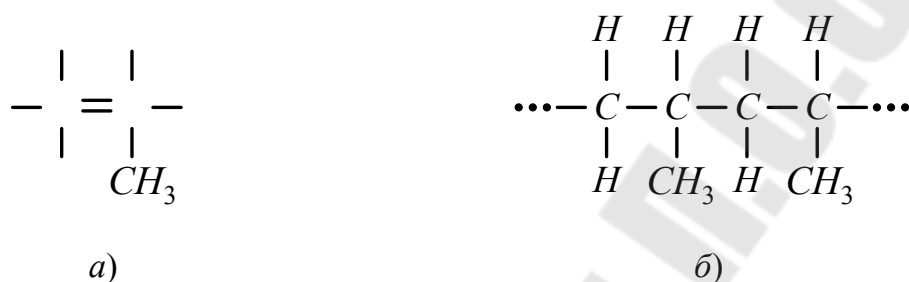
Рис. 8.9. Молекула пропилена (а) и молекула полипропилена (б)
