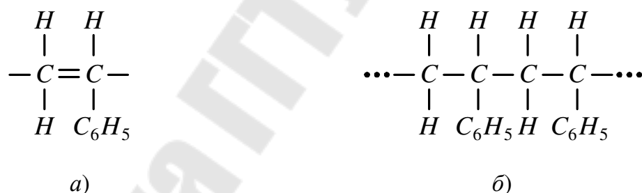
Рис. 8.1. Молекула стирола-мономера (а) и молекула полистирола (б)
