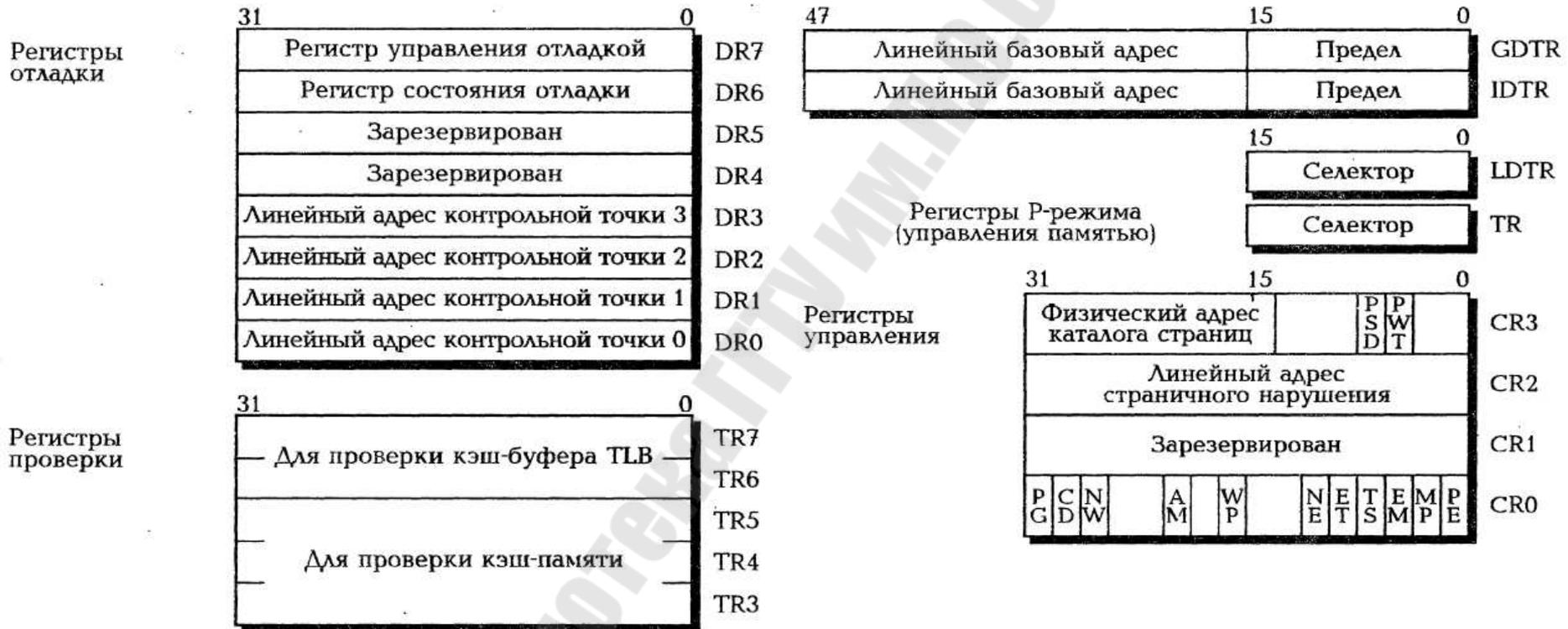
Системные регистры *GDTR*, *LDTR* и *IDTR* введены начиная с i80286 и предназначены для хранения базовых адресов таблиц дескрипторов при работе в защищенном режиме.
