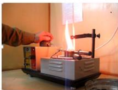
Рис. 1 – Лабораторная работа «Определение температуры вспышки горючих веществ»
