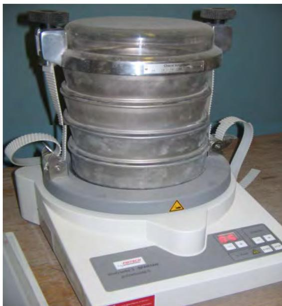
**Рисунок 4. – Классификатор фирмы Fritsch**
