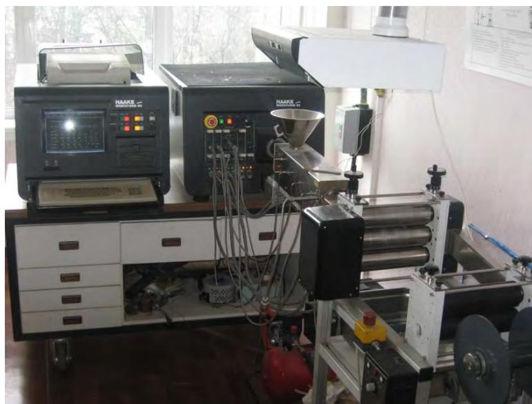
**Рисунок 5. – Компьютеризированный экструзиограф «Rheocord 90» фирмы «НААКЕ»**
