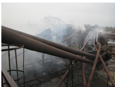
Рисунок 2 – Повреждения технологического оборудования: а – системы аспирации снаружи производственного здания; б – технологического оборудования внутри помещения
