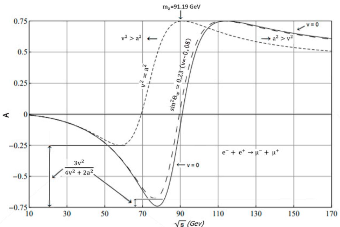
Рисунок 1 – Энергетическое поведение асимметрии вперед-назад  $A_{FB}$  в процессе аннигиляционного рождения мюонных пар. Указаны различные возможные комбинации констант связи  $Z$ -бозона с лептонами – как в СМ, при  $v=a=1$  и  $v=0$
