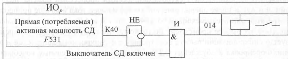
Рис. 6. Предлагаемая схема формирования выходного сигнала ИО р в реле СД
