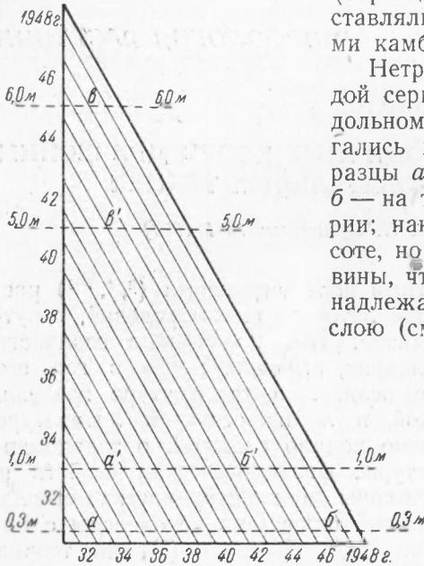
Рис. 1. Схема размещения сопоставляемых образцов древесины в продольном сечении ствола дерева
