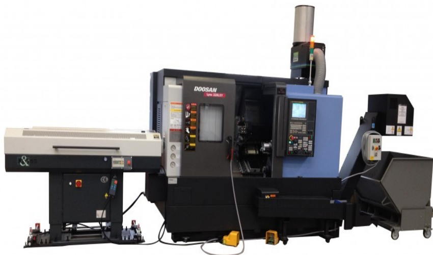
Рисунок 1 – Прутковый токарно-винторезный станок швейцарского типа DOOSAN LYNX
