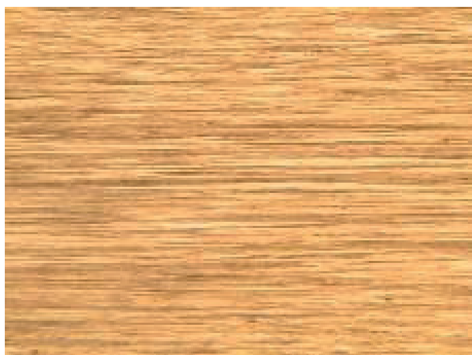
Рис. 4. Неравноосная микроструктура в продольном сечении проволоки после волочения ( \times 200 )
