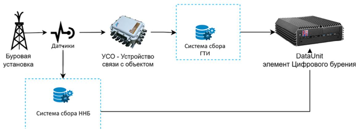
Рис. 1. Принципиальная схема движения информации для системы АМЭС
