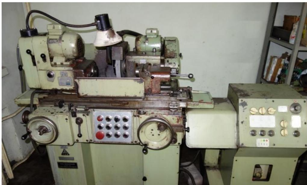
Рис. 3. Круглошлифовальный станок модели BUA-16
