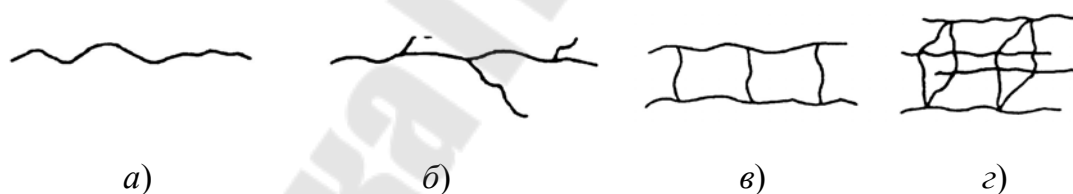
Рисунок 2 – Формы макромолекул полимеров: a – линейная; б – разветвленная; в – лестничная; г – сетчатая
