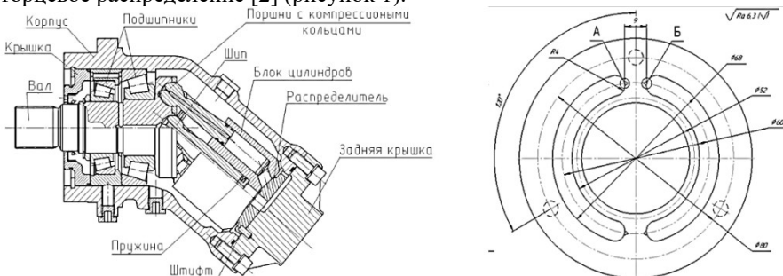
Рис. 1. Конструкция аксиально-поршневого насоса с торцевым распределением жидкости
