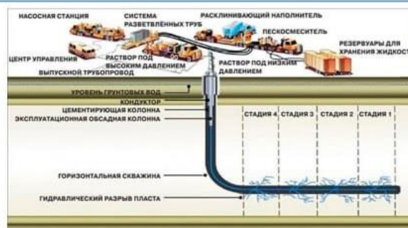
Рис 1. Схема ГРП в горизонтальной скважине
