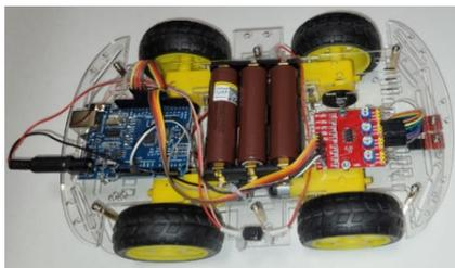
Рисунок 1 – Мобильная платформа, отслеживающая линию
