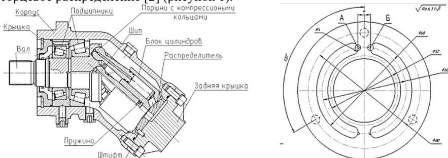
Рис. 1. Конструкция аксиально-поршневого насоса с торцевым распределением жидкости
