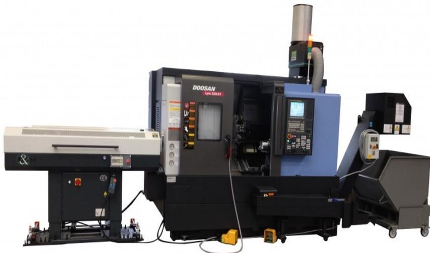
Рисунок 1 – Прутковый токарно-винторезный станок швейцарского типа DOOSAN LYNX
