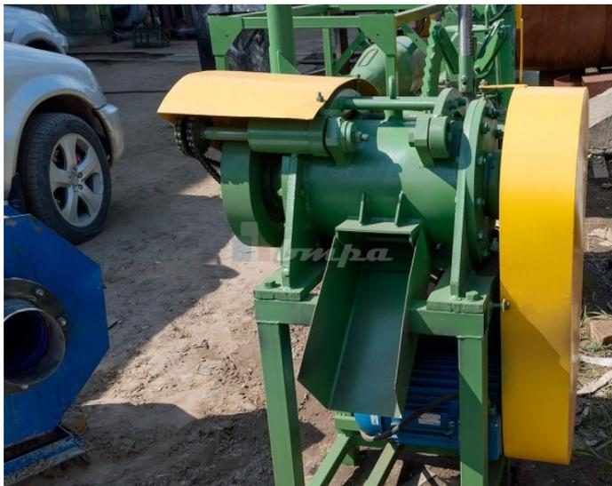
Рисунок 1 – Установка по утилизации автомобильных шин
