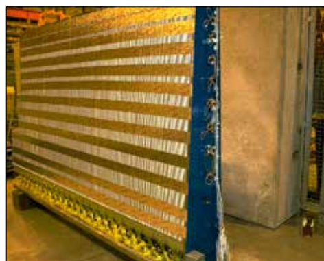
Рис. 2. Конструкционные элементы адронного калориметра коллаборации ATLAS, изготовленные в Республике Беларусь (CERN, Женева, 2005 г.)
