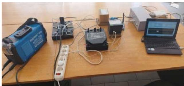
*Рис. 1.* Схема определения влияния сварочного аппарата марки Solaris MMA-208 на качество электроэнергии
