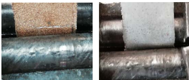
Рис. 2. Испытания образцов: а – двухслойный; б – трехслойный
