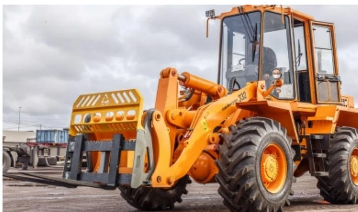
*Рис. 1. Погрузчик фронтальный одноковшовый АМКОДОР 332В*
