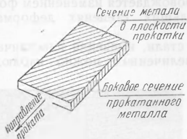
Рис. 2. Расположение сечений прокатанного материала, подвергнувшегося исследованию (схема)
