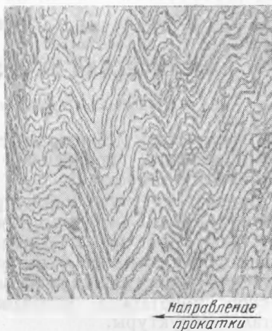
Рис. 3. Изогнутые пластины цементита в боковом сечении прокатанной стали с 0,82% углерода, обжатой на 68%. Травитель тот же, \times 2500 .
