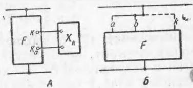
Рис. 1. Схемы, иллюстрирующие выделение цепей отдельных элементов: А — элемента  $X_k$ ; Б — начальных элементов
