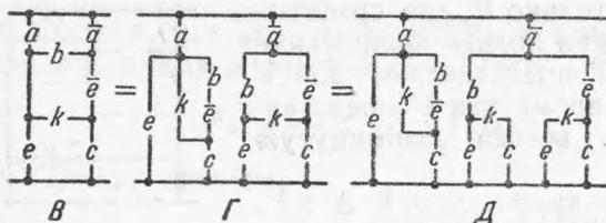
Рис. 4. Схемы, иллюстрирующие выделение цепей, воздействующих на элемент  $V$
