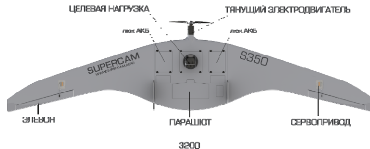
Рис. 2. БПЛА самолетного типа Суперкам S350
